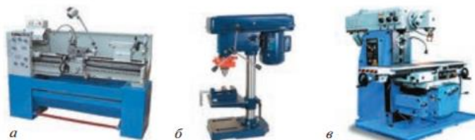
Рис. 10.8. Металлорежущие станки: а — токарный по металлу; б — сверлильный; в — фрезерный
