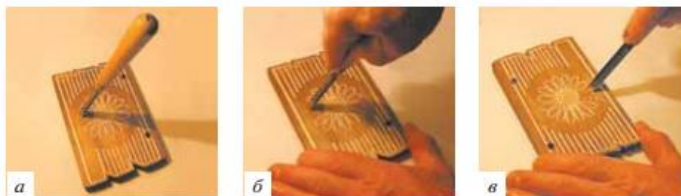
Рис. 8.24. Техника резьбы: а — начальное положение полукруглой стамески при наcolке; б — приём наcolки; в — приём подрезки
