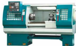
Рис. 5.13. Универсальный токарно-винторезный станок с ЧПУ российского производства
