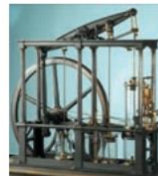
Рис. 9.7. Паровая машина Дж. Уатта
