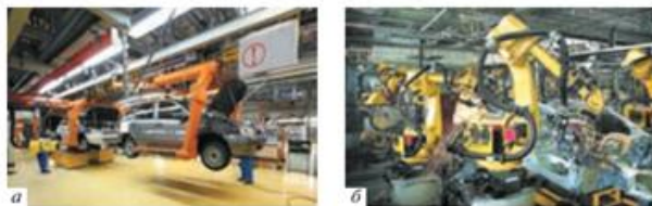
Рис. 9.2. Использование машиностроительных технологий: а — сборочный конвейер на автомобильном заводе; б — автоматическая линия на машиностроительном заводе
